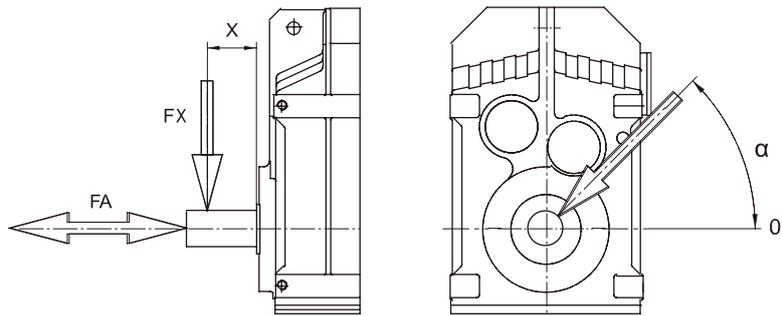
FX = 在 X 点的许用径向力 / Permitted overhung load at point X [N]
