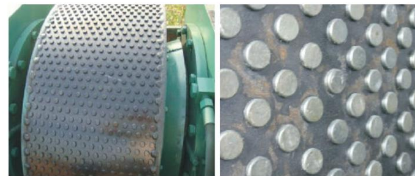
硬质合金柱钉辊面适用于普氏硬度5~16的矿石，寿命为30000~6000小时
