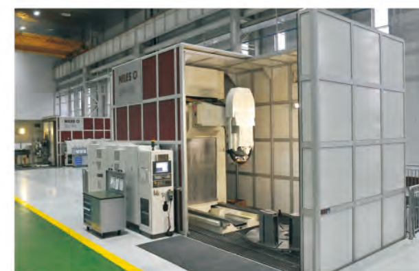
德国NILES公司高精度数控成型磨齿机 ZPI 30 (磨内齿最大加工直径Φ3000mm) Germany NILES Gear Profile Grinding Machine (Internal grinding, Max. Φ3000mm)
