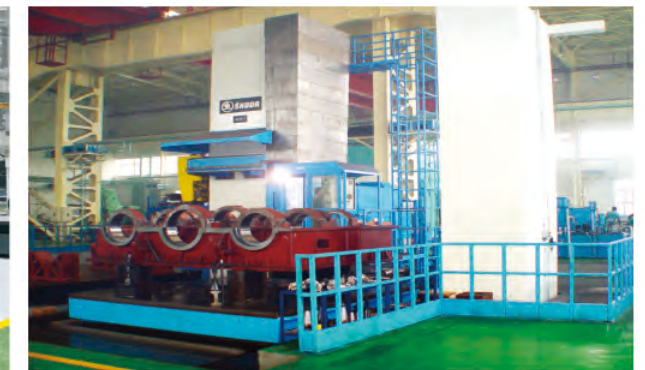
捷克SKODA公司大型数控落地镗铣床: 镗杆直径: φ225 行程 X=11500 Y=4500 Z=1600 Czech SKODA Large-scale Floor-type Boring & Milling Machine: Rod Diameter:φ225 Travel:X=11500 Y=4500 Z=1600
