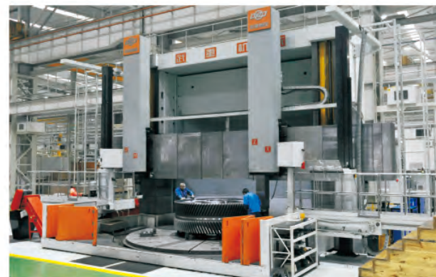
数控双柱立式车床 CKD5263×40/63 (最大车削直径 Ø 6300mm) NC Turning Machine (Max. Ø 6300mm)
