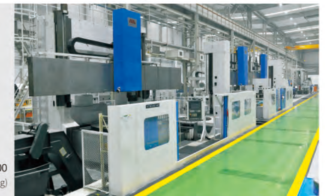
捷克SKODA公司大型数控落地镗铣床: 镗杆直径: φ225 行程 X=11500 Y=4500 Z=1600 Czech SKODA Large-scale Floor-type Boring & Milling Machine: Rod Diameter:φ225 Travel:X=11500 Y=4500 Z=1600
