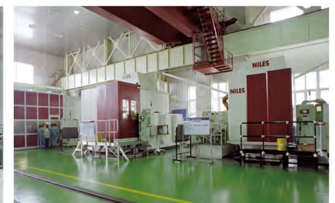
德国NILES公司生产的高精度数控成型磨齿机ZP40/4000(可磨内齿)、ZP20/2000(可磨内齿)、ZP80/800、加工精度DIN3级 Germany NILES Gear Profile Grinding Machine ZP40,ZP20,ZP80(capable of grinding internal gear),DIN-3Class
