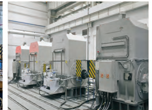
2X6500KW试验台(最大试车功率13MW) Test Bench(Max.Power 13MW)
