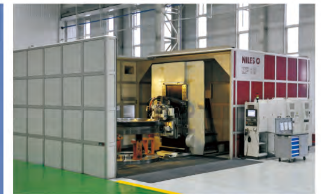
德国NILES 公司高精度数控成型磨齿机 ZP50 (最大加工直径Φ5000mm) Germany NILES Gear Profile Grinding Machine (Max. Φ5000mm)
