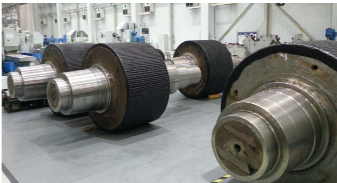
堆焊辊面适用于普氏硬度 5~16 的矿石，寿命为 8000~1200 小时
